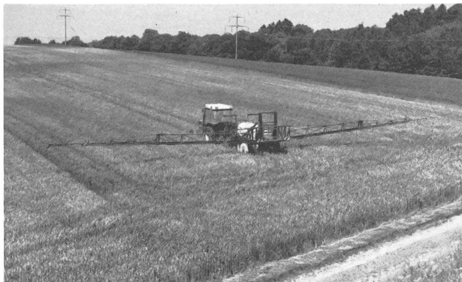
Fig. 3: ... en position de travail totale (24 m de largeur). Autres largeurs possibles: 18 ou 12 m.
