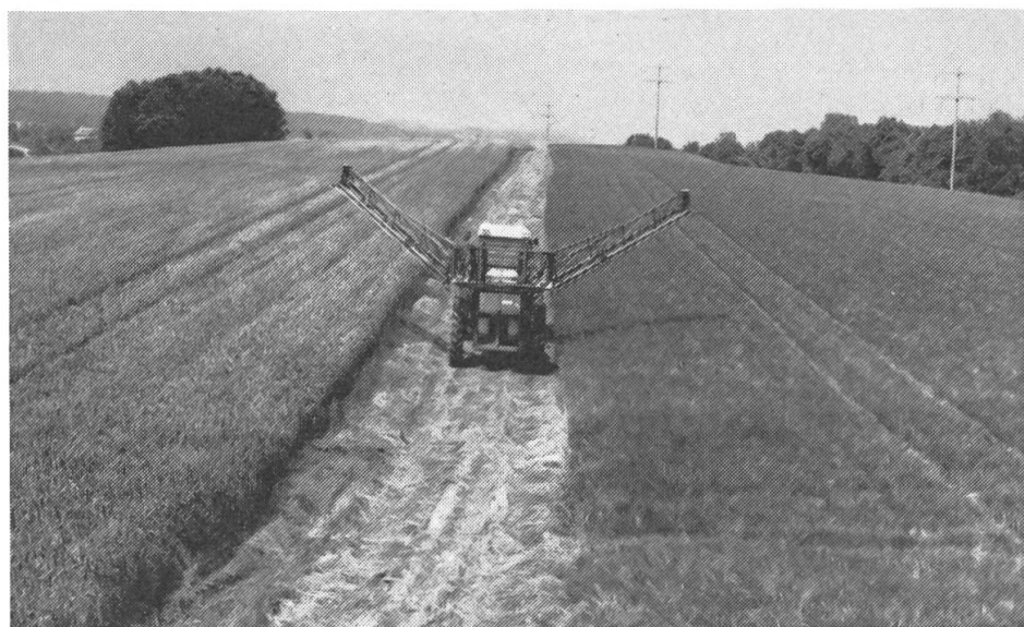
Fig. 2: La même machine en position de transport dans un champs. Pour travailler, la barre est de chaque côté adaptable à la configuration du terrain...
