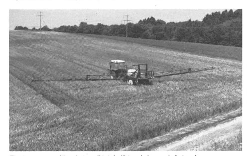
Fig. 3: ... en position de travail totale (24 m de largeur). Autres largeurs possibles: 18 ou 12 m.
