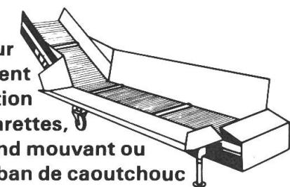
Convoyeur de déchargement et d'alimentation chaîne à barettes, fond mouvant ou ruban de caoutchouc
