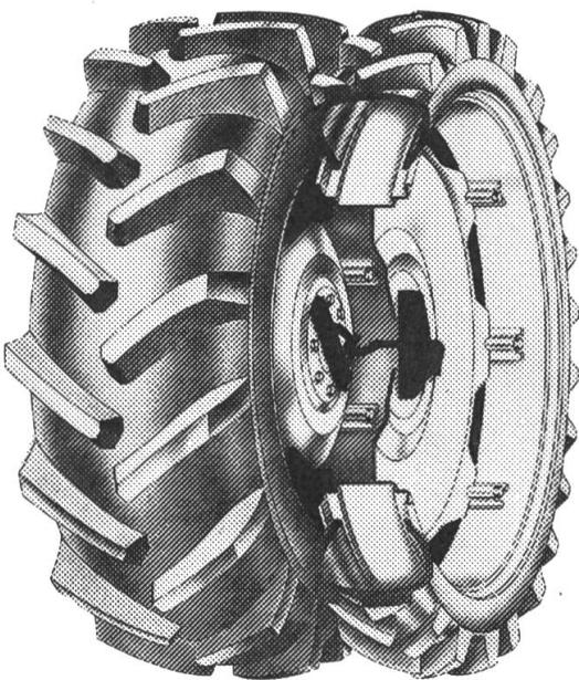
Grâce au système AW d'accouplement des roues jumelées GS. Que la roue montée sur votre tracteur soit large ou étroite, l'autre roue se fixe automatiquement et est immédiatement utilisable comme roue jumelée sans modifications désagréables. Notre principe est sans pareil sur le marché européen et des attestations internationales le prouvent.
