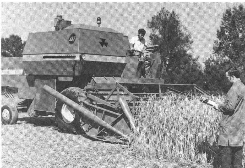
Fig. 1: Les mesurages exacts du temps de travail, de l'importance des influences techniques et surtout des facteurs climatiques pendant le moissonnage-battage donnent les bases pour une amélioration de l'utilisation de la machine.
