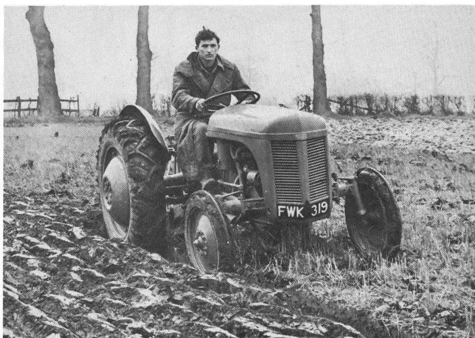
Fig. 5: Le fameux modèle TE 20 Massey Ferguson, à l'origine 23,9 CV et plus tard 28,5 CV. Après 1951: 34 CV.
