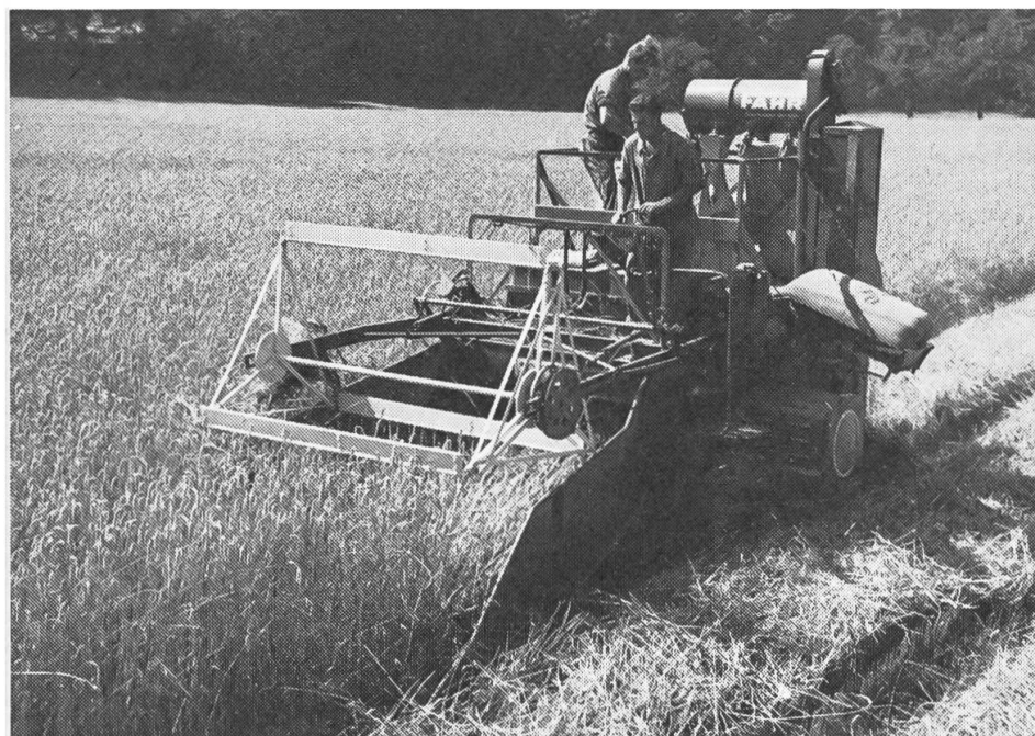
Fig. 1: Les débuts historiques du moissonnage-battage. Le moteur Diesel «Hannomag», monté latéralement, était la seule partie parfaite du point de vue technique sur cette machine.
