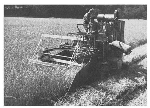
Fig. 1: Les débuts historiques du moissonnage-battage. Le moteur Diesel «Hanomag», monté latéralement, était la seule partie parfaite du point de vue technique sur cette machine.
