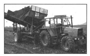
V 200 décolleteuse-arracheuse-chargeuse de betteraves, traînée, à deux rangs.
