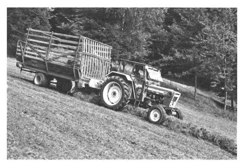
Fig. 4: La mécanisation au moyen d'un tracteur atteint sa limite de rentabilité dès que la déclivité du terrain correspond à env. 35 %.
