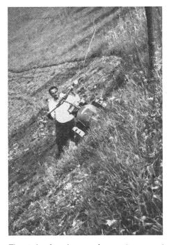
Fig. 1: La faucheuse de montagne est de loin la faucheuse la mieux adaptable aux terrains déclives et la plus économique. Ses performances par unité de surface sont toutefois modestes.
