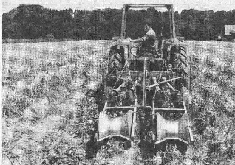
Fig. 6: L'arracheuse de fanes Nimos (pour laquelle il n'y a pas de représentation suisse) abat les fanes jusqu'à une longueur de tige résiduelle de 30 à 35 cm puis les arrache au moyen de courroies de caoutchouc (à droite). Au niveau d'une vitesse circonférentielle des courroies réglable entre 2,5 et 3,2 m/s, la vitesse de marche optimale se situe entre 2,6 et 3,5 km/h, à la condition que les billons soient hauts et réguliers et la machine correctement réglée.
