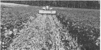
Fig. 3: L'effaneuse à chaînes à quatre rangs (Gehring, Matzingen) permet d'abattre les fanes à longueur utile et de blesser les tiges résiduelles, en opérant à la vitesse de 5 à 6 km/h.
