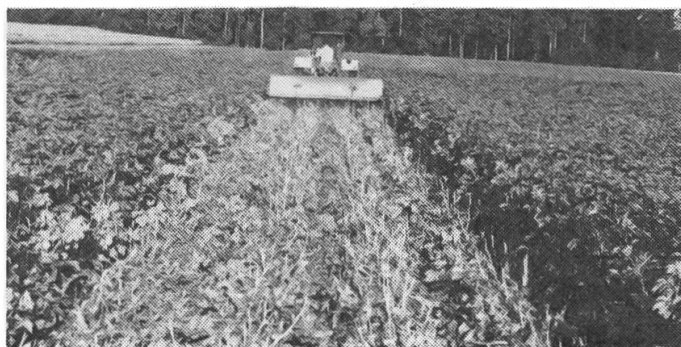
Fig. 3: L'effaneuse à chaînes à quatre rangs (Gehring, Matzingen) permet d'abattre les fanes à longueur utile et de blesser les tiges résiduelles, en opérant à la vitesse de 5 à 6 km/h.
