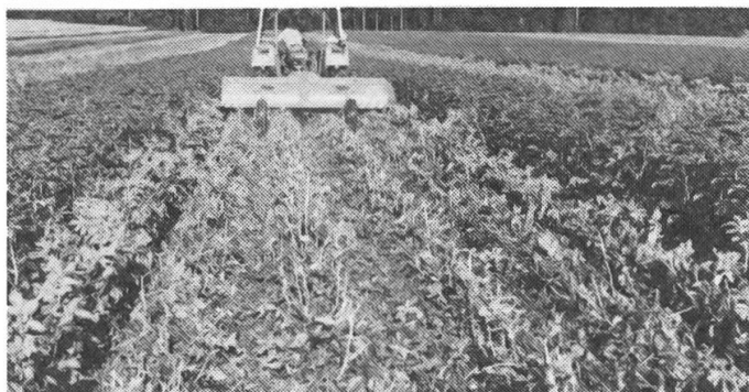
Fig. 4: L'effaneuse à dents à quatre rangs Gruse (Müller, Bättwil) cassent les fanes et fend les tiges à une hauteur que les galets d'appui au sol permettent de régler. Faute de tôles de guidage, une partie des fanes abattues (comme avec l'effaneuse à chaînes) recouvre les tiges résiduelles et rend ainsi le dépôt de la bouillie plus difficile.
