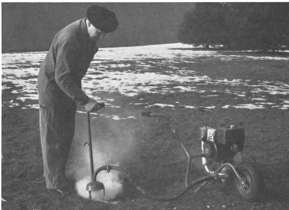
Fig. 3: Une épaisse fumée n'est pas nécessairement signe d'efficacité des gaz d'échappement (Photo du LFEM).
