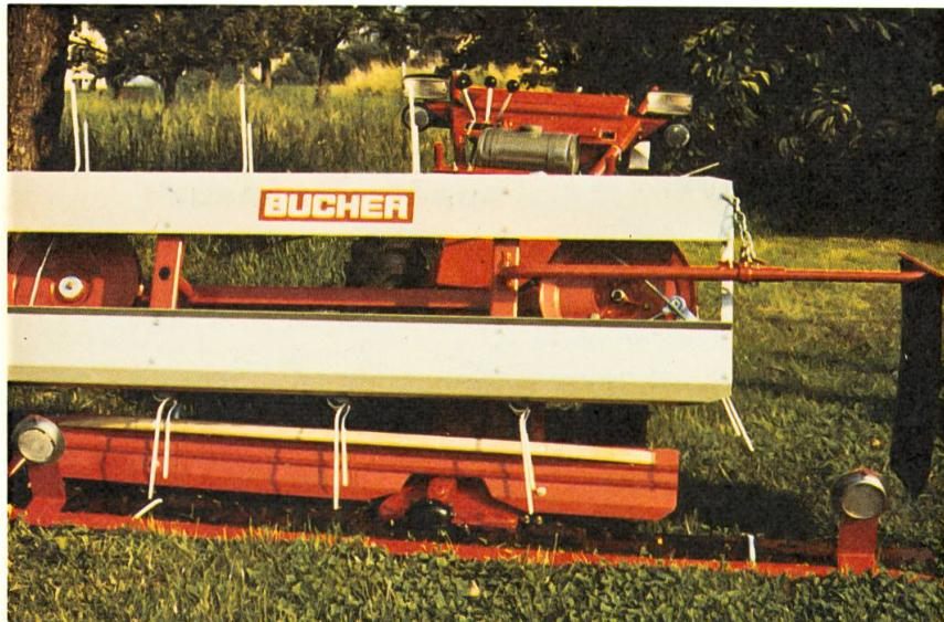
*Enfin le printemps! C'est la première fois cette année que l'on peut faucher l'herbe. La motofaucheuse d'oncle Frédy est équipée de façon exemplaire. La protection de la barre munie de catadioptrès couvre les parties dangereuses et signale en même temps la largeur de la barre de coupe. Uncle Frédy a, bien entendu, aussi obtenu la plaque d'assurance obligatoire (numéro du vélo). Sans celle-ci, en cas d'accident, la motofaucheuse ne jouit pas de l'assurance responsabilité civile.*
