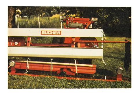
Enfin le printemps! C'est la première fois cette année que l'on peut faucher l'herbe. La motofaucheuse d'oncle Frédy est équipée de façon exemplaire. La protection de la barre munie de catadioptres couvre les parties dangereuses et signale en même temps la largeur de la barre de coupe. Oncle Frédy a, bien entendu, aussi obtenu la plaque d'assurance obligatoire (numéro du vélo). Sans celle-ci, en cas d'accident, la motofaucheuse ne jouit pas de l'assurance responsabilité civile.
