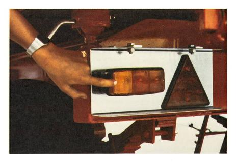
Pendant l'hiver, la remorque auto-chargeuse a été sérieusement révisée. Les réparations ne se sont pas uniquement étendues au dispositif de ramassage (pick-up) et au fonds mouvant. L'installation d'éclairage et de clignoteurs a également dû être mise au point. Marcel a, en même temps, remplacé les catadioptres triangulaires défectueux.
