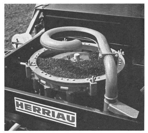
Fig. 3: Dans ce semoir monograine pour betteraves sucrières, les semences sont transmises aux agrégats semeurs au moyen d'un disque à alvéoles dont la vitesse de rotation est proportionnelle à celle de l'avancement du tracteur. Le flux des semences est contrôlé par des détecteurs électroniques.
