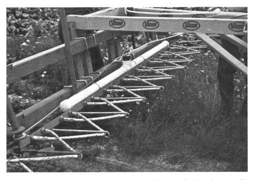
Fig. 5: Les mauvaises herbes dont la hauteur dépasse celle des plantes cultivées (p.ex. des betteraves montées en graine) entrent en contact avec des mèches imprégnées d'un herbicide. La consommation des produits phytosanitaires est alors extrêmement réduite.
