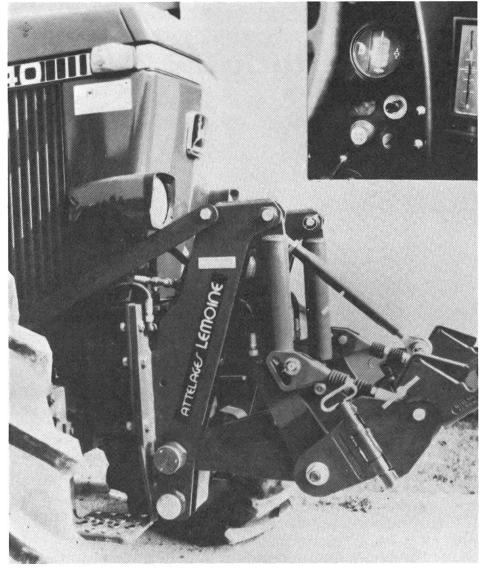
Fig. 1: L'adjonction d'un système hydraulique frontal et d'une prise de force avant permet de mieux utiliser le tracteur et d'améliorer son rendement effectif. Photo d'un système hydraulique frontal comportant un indicateur de positionnement.
