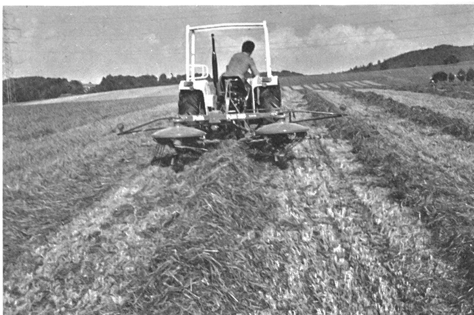
Fig. 3: Faneuse «combi» formant des andains. La plupart de ces machines polyvalentes poussent le fourrage vers la ligne centrale et ne parviennent par conséquent pas à former des andains de n'importe quel volume. Elles ne permettent pas non plus de contourner des obstacles aussi facilement que des modèles à décharge latérale.
