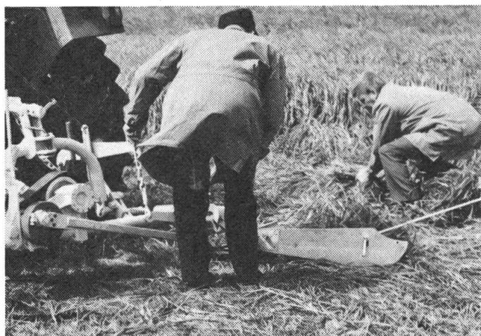
Fig. 8: Deux hommes ne sont pas indispensables en général pour faucher avec une machine à barre de coupe à doigts; mais il faut compter avec le bourrage.
