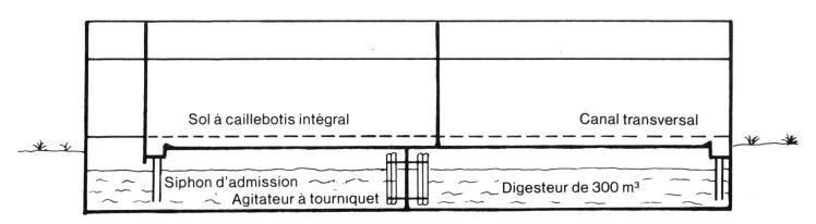
Fig. 3: Croquis de la porcherie d'engraissement avec l'installation de biogaz de H. Güntensperger.
