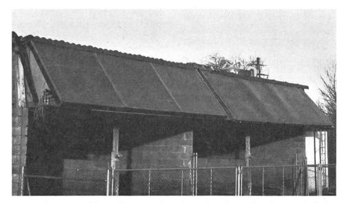
Fig. 1: Capteur solaire utilisé pour la préparation d'eau chaude soumis à des tests comparatifs pratiques entrepris par la Station de recherche de Tänikon (FAT).
