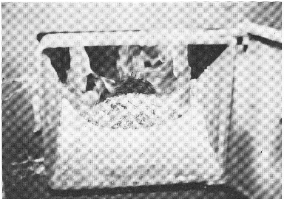
Fig. 4: Débit continu de copeaux dans le brûleur.
