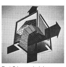
Fig. 1: Echangeur de chaleur à courant inversé.
