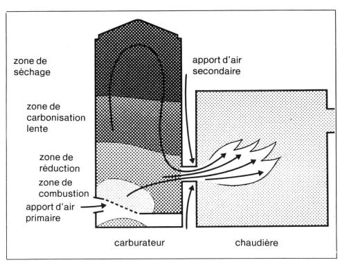
Fig. 5: Schéma de fonctionnement du brûleur de gaz de bois.
