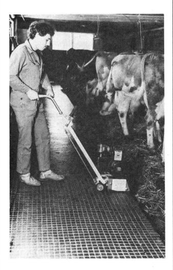
Pour éviter de glisser sur ces sols lisses, la surface peut être striée dans le sens de la longeur ou en croix avec la machine Von Arx FR-200 pour les traitement des surfaces.
