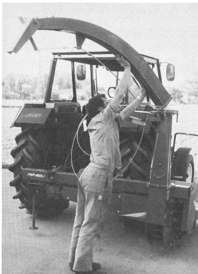
Fig. 5: La goulotte d'éjection doit être rabattable à mi-hauteur sur toutes les hacheuses à maïs.
