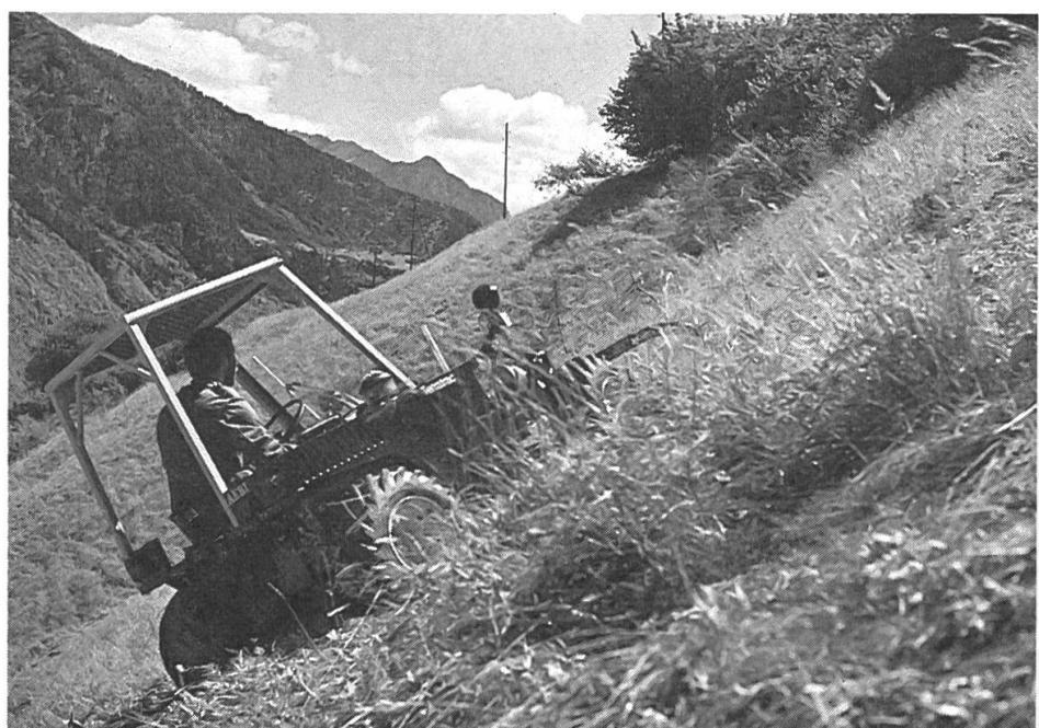
rer les remorques à un essieu et à superstructures. On peut combiner certains travaux, tels que faucher à l'aide du dispositif frontal et charger simultanément la ration journalière de fourrage vert sur l'autochargeuse remorquée. C'est un argument militant en faveur du tracteur-faucheur; cette utilisation n'est cependant pas sans danger sur les terrains aux pentes vraiment fortes.
