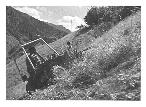
rer les remorques à un essieu et à superstructures. On peut combiner certains travaux, tels que faucher à l'aide du dispositif frontal et charger simultanément la ration journalière de fourrage vert sur l'autochargeuse remorquée. C'est un argument militant en faveur du tracteur-faucheur; cette utilisation n'est cependant pas sans danger sur les terrains aux pentes vraiment fortes.
