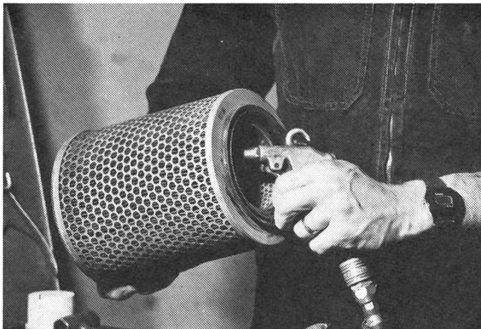
Fig. 4: Soufflage d'une cartouche de filtre à sec.
