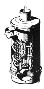
Fig. 3: Organes d'un filtre à air à sec.
