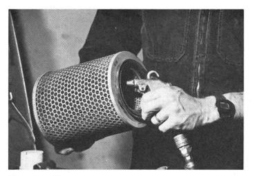
Fig. 4: Soufflage d'une cartouche de filtre à sec.
