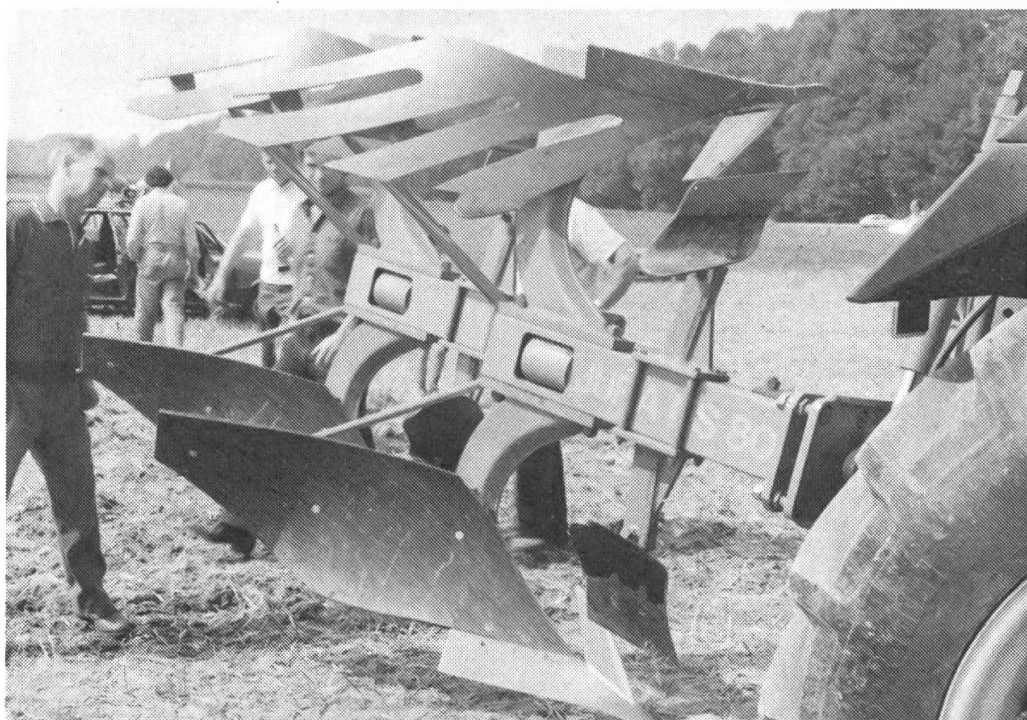
Fig. 2: Une charrue expérimentale permettait d'étudier les effets obtenus au moyen de versoirs en plastique ou à claire-voie.
