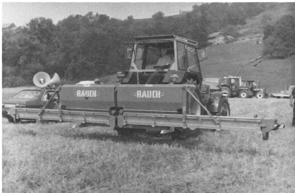
Fig. 4: Ce distributeur d'engrais Exakt assure d'un bout à l'autre du champ une application très précise d'engrais d'une consistance quelconque.
