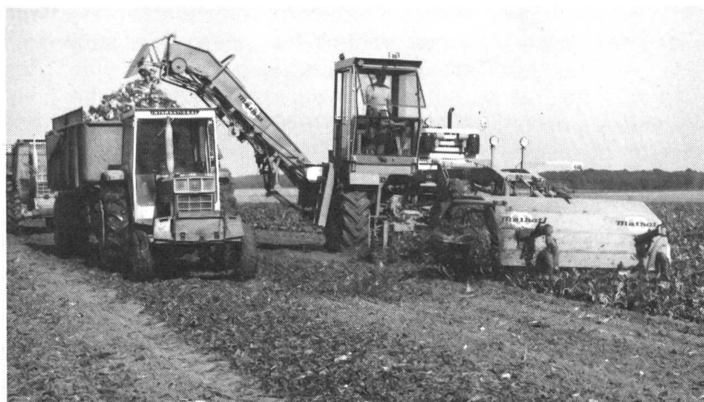
Fig. 6: Effeuilleuse-arracheuse-chargeuse de betteraves (automotrice à 6 rangs).
