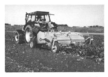
Fig. 3 + 4: Système de récolte à deux phases (décolleteuse-arracheuse à dispositif de déchargement, à six rangs).
