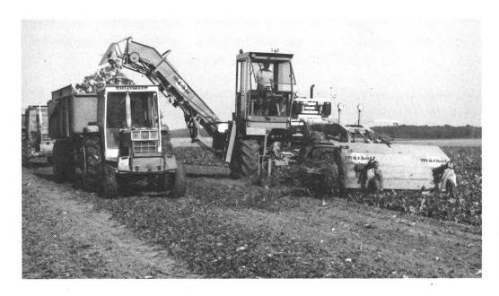
Fig. 6: Effeuilleuse-arracheuse-chargeuse de betteraves (automotrice à 6 rangs).
