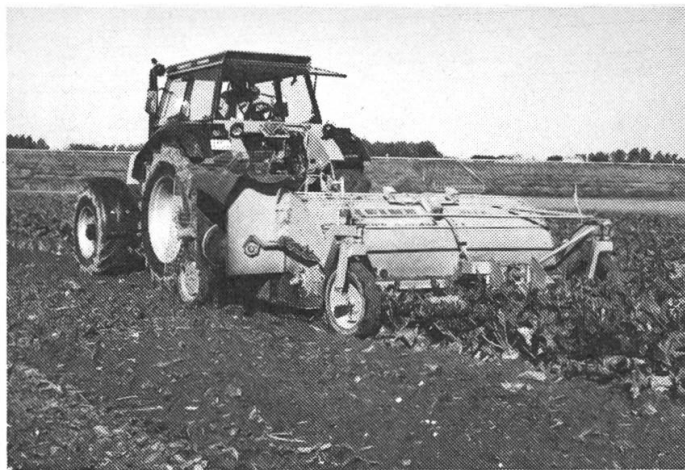
Fig. 3 + 4: Système de récolte à deux phases (décolleteuse-arracheuse à dispositif de déchargement, à six rangs).
