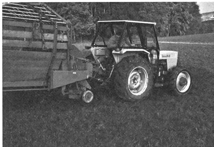
Fig. 10: Avec essieu avant tracté, on a pu franchir des rampes pratiquement deux fois plus fortes.
