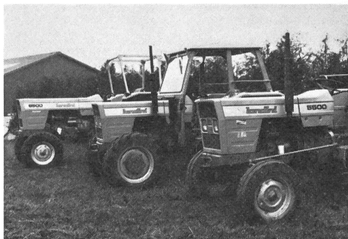
Fig. 1 Tracteurs engagés dans l'essai: Tracteur normal et tracteur à traction intégrale de même puissance, ainsi que tracteur normal plus puissant de même prix que le tracteur à traction intégrale.
