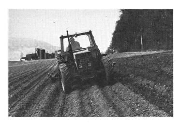
Fig. 11: Des valeurs de glissement et de dérive moindres ont été mesurées dans la culture en terrain déclive.
