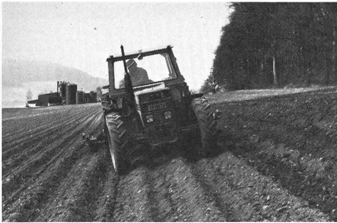
Fig. 11: Des valeurs de glissement et de dérive moindres ont été mesurées dans la culture en terrain décline.
