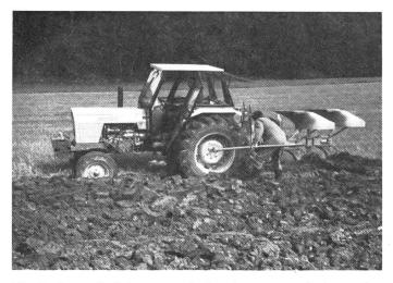
Fig. 5: Lors du labourage, le tracteur normal plus puissant, dans pratiquemnt tous les cas, a pu être engagé avec un rapport de boîte immédiatement supérieur.
