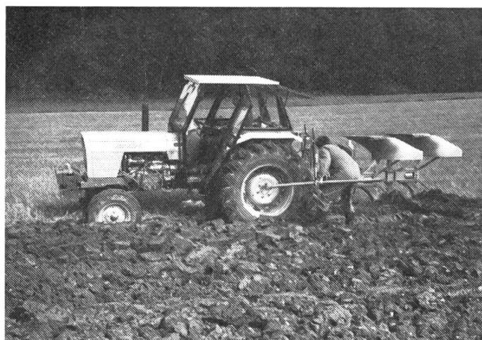
Fig. 5: Lors du labourage, le tracteur normal plus puissant, dans pratiquement tous les cas, a pu être engagé avec un rapport de boîte immédiatement supérieur.
