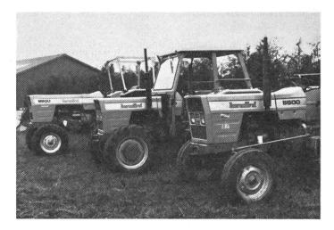
Fig. 1 Tracteurs engagés dans l'essai: Tracteur normal et tracteur à traction intégrale de même puissance, ainsi que tracteur normal plus puissant de même prix que le tracteur à traction intégrale.
