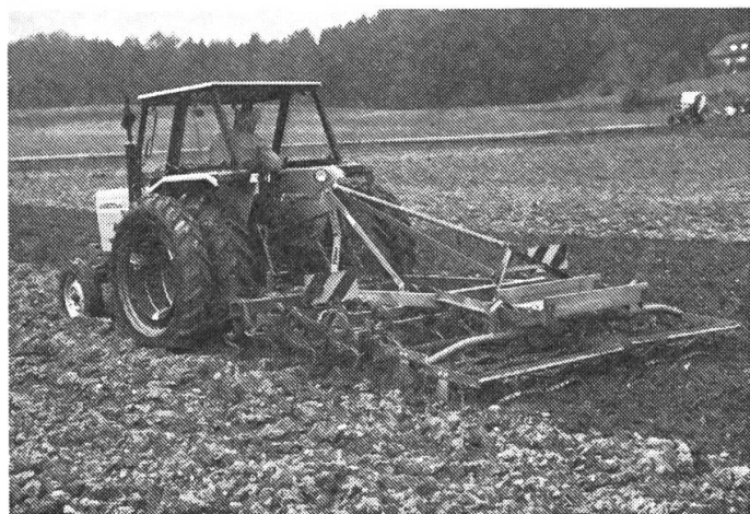
Fig. 7: Les pneumatiques jumelés ont permis de réduire le glissement dans une proportion décisive.
