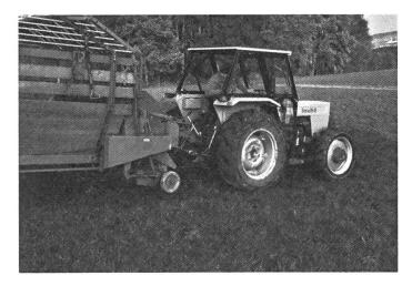
Fig. 10: Avec essieu avant tracté, on a pu franchir des rampes pratiquement deux fois plus fortes.
