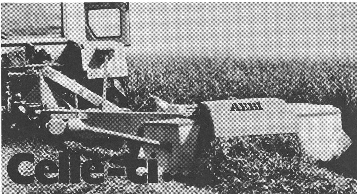
Faucheuse conditionneuse avec conditionneuse relevable et démontable. Réglage sans intervalles du degré de préparation du fourrage. Largeurs de travail 1,65, 1,90 et 2,10 m.
