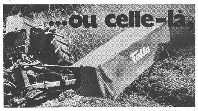
Faucheuses à disques SM 165, SM 205 et SM 240 Largeurs de travail 1,65, 2,05 et 2,40 m. 4 ou 6 disques à 2 couteaux. Commande par courroies trapézoïdales et engrenages dans bain d'huile. Dispositif de sécurité contre l'endommagement. SM 240 avec relevage hydraulique. Grande adaptation au sol et poids minime: idéal pour les exploitations de montagne et dans les terrains accidentés.
