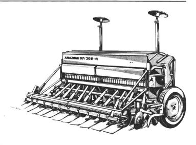
verts de chaume, mais également utilisable dans les sols proprement préparés. Le limiteur de profondeur antibourrage permet de respecter la profondeur d'ensemencement requise même dans les sols de nature très changeante.
