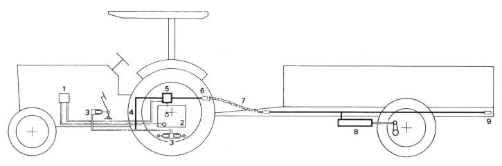
Fig. 11: Frein de remorque hydraulique, commande par la pédale du tracteur et impulsion
