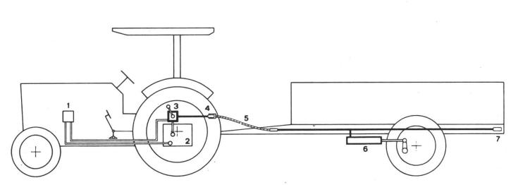
Fig. 10: Variante la plus simple d'un frein de remorque hydraulique: commande par simple levier.
