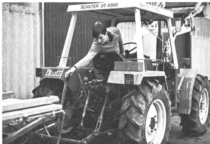
Fig. 1: Le frein de remorque avec le levier à main sur le timon du tracteur appartient-il au passé?
