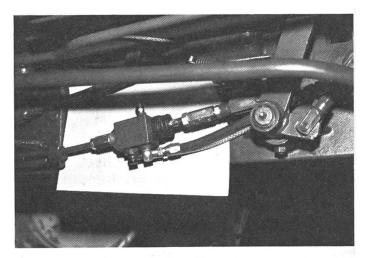
Fig. 4: Le capteur de pression est monté dans la tringlerie de freinage.
