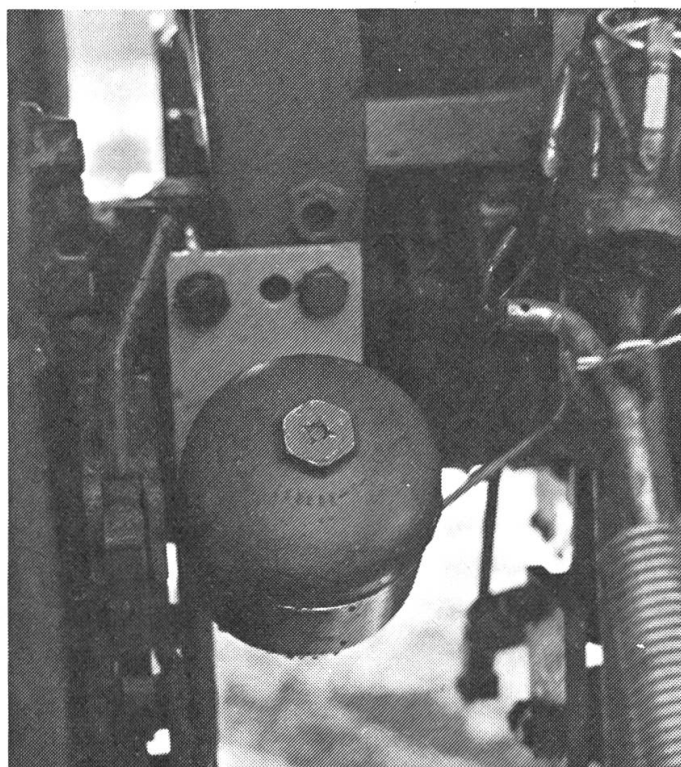
Fig. 7: Si le tracteur est équipé d'accumulateurs hydrauliques, on peut freiner, même en cas de panne du moteur.
