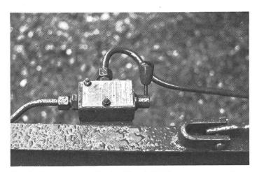
Fig. 3: La soupape d'adaption à la charge ne remplace pas la soupape de freinage hydraulique pour remorque. Il s'agit d'en équiper le tracteur par pure réflexion pratique.
