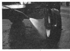
Fig. 1: Les parties fort sollicitées telles que les paliers et parties de l'installation électrique etc. doivent être jiclées à une distance suffisante avec le jet large ou en éventail...
