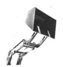
Pelle à bennage par surélévation hydr.
