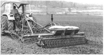
Fig. 4: Dans la préparation du lit de semences de maïs, ce sont le Crosskill et le Crosskill d'incision qui ont donné l'émottage le meilleur. L'effet d'émottage du rouleau d'incision et en particulier du rouleau en spirale s'est révélé de qualité un peu inférieure (sol marécageux, labour de printemps). Le timon du rouleau en spirale, un peu trop court dans cette combinaison, convient plutôt à la gueule d'attelage du tracteur.
