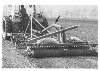
Fig. 3: L'essai de rouleau combiné à un cultivateur fin, pour la préparation du lit de semences de betteraves sucrières en sol marécageux, s'est déroulé dans des conditions optimales. Le long timon coudé du Cambridge (à gauche) permet pratiquement d'atteler toutes les machines (à droite: rouleau d'incision) également à une herse légère.
