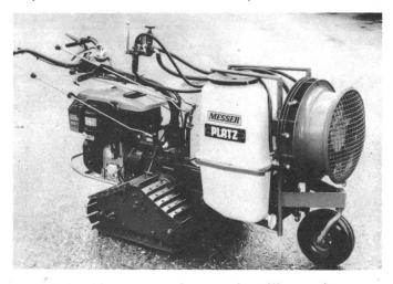
est plein. Une roue de soutien libre, pivotante sur 360°, a de même été adaptée en tant qu'élément de soutien. Il est possible de travailler en avant et en arrière (selon le terrain). L'exploitation de cette combinaison est intéressante dans les vignobles en pente et autres cultures en ligne présentant un espace minimal de 1,1 m. Le même motoculteur peut être équipé de bêcheuses 66/95 cm, fraises, etc.
