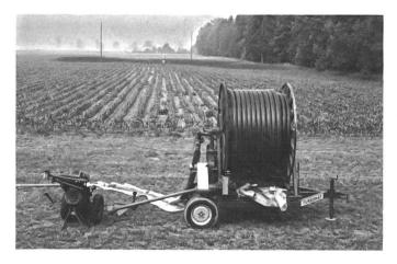
Fig. 6: Actionnement simple et bon marché du tambour enrouleur au moyen d'une motofaucheuse.
