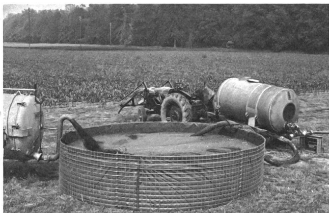
Fig. 5: La performance d'une installation d'aspersion peut être fortement augmentée en introduisant un stockage intermédiaire du lisier.
