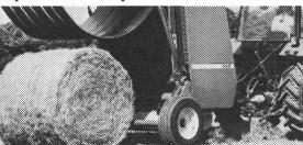
La pré-compression par le nouveau rabatteur réglable commence directement au pick-up et reste constante quelles que soient les dénivellations ou les différents réglages de hauteur de ramassage. Caractéristique importante du système John Deere: l'alimentation par vis sans fin s'adaptant automatiquement au volume de la récolte. Elle permet de diriger en flux continu et régulier le fourrage précomprimé vers le canal. Sur les plus gros modèles, un
