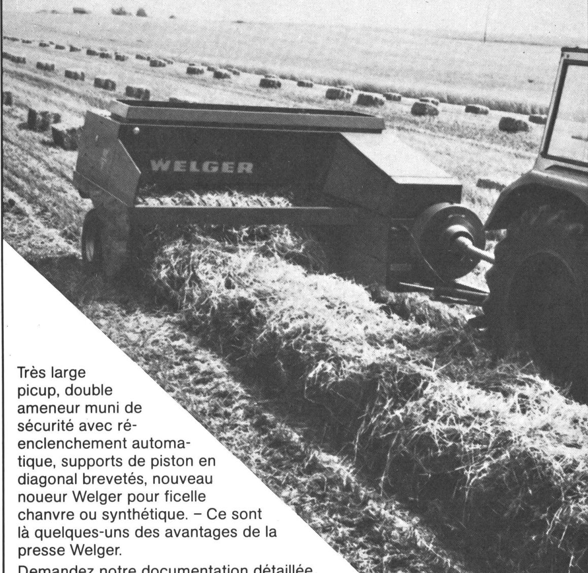
Très large pickup, double ameneur muni de sécurité avec ré-enclenchement automatique, supports de piston en diagonal brevetés, nouveau noueur Welger pour ficelle chanvre ou synthétique. – Ce sont là quelques-uns des avantages de la presse Welger.
