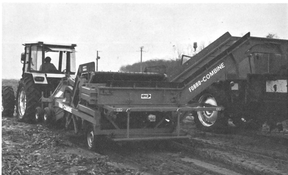
Fig. 3: La Fobro Combine, une récolteuse totale pour baies.
