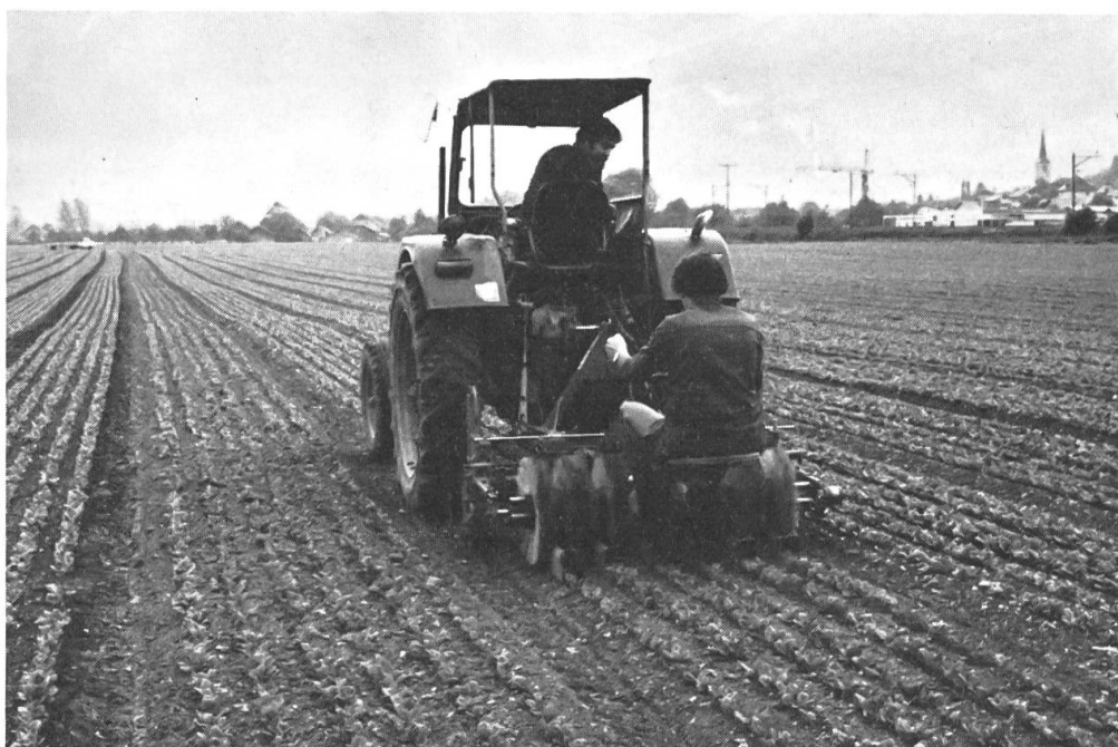
Fig. 4: La nouvelle brosse bineuse pour la destruction mécanique des mauvaises herbes.
