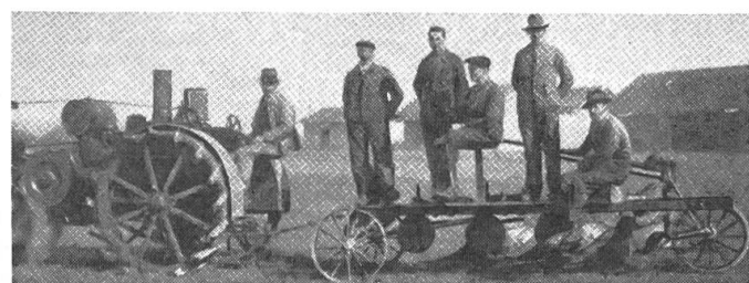
Tracteur Mogul importé par International Harvester Company, Zurich. Moteur de 18 CV à pétrole, monocyl., charrue américaine de 2 ou 3 socs. Instantané pris à Frauenfeld en 1918, lors du premier concours pour conducteurs de tracteurs.
