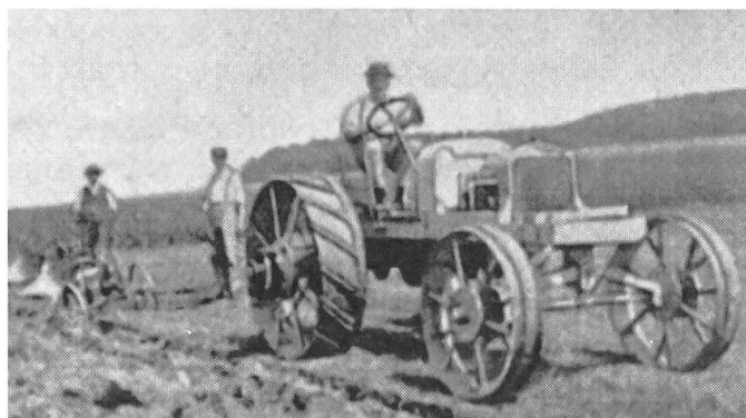
Tracteur lourd construit au moyen de divers éléments provenant de camions et pourvu d'un moteur Martini (1919 env.).
