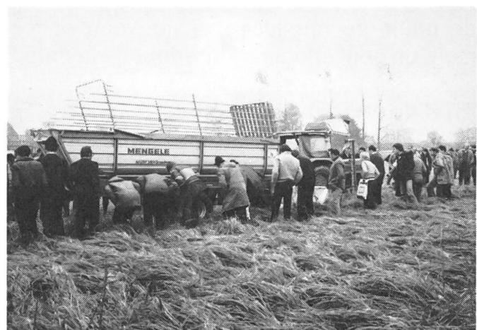
Au lieu d'une faucheuse autochargeuse conventionnelle, les établissements Mengèle produisent actuellement le modèle MLW 310 Quadro qui représente une combinaison intéressante d'un dispositif de coupe à disques de 1650 mm de large et d'un pick-up. Cette faucheuse autochargeuse Mengèle à 25 points de coupe permet de ramasser non seulement du fourrage vert fraîchement fauché, mais aussi du fourrage andainé « normalement », car le dispositif de coupe à disques peut alors être relevé
