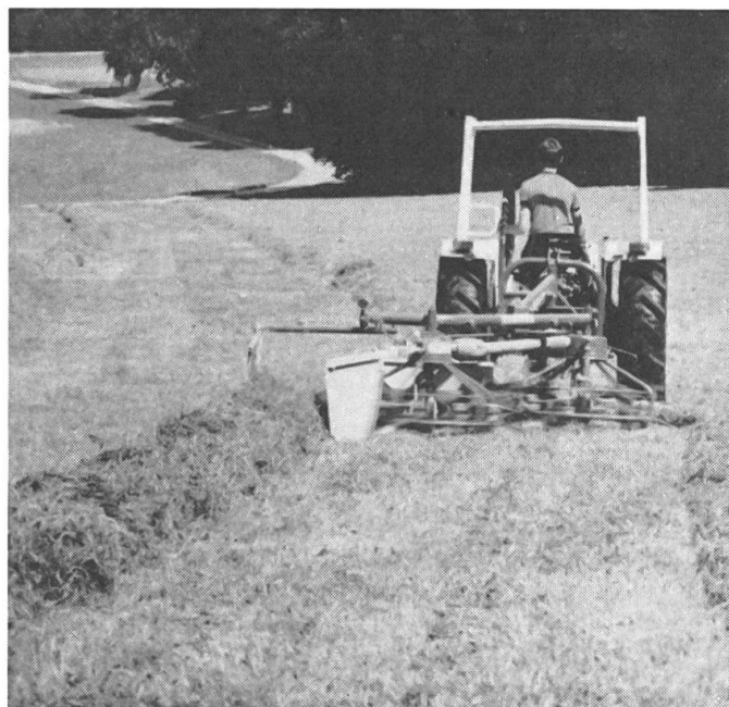
Fig. 3: Les faneuses combi amassent généralement le fourrage vers le milieu de l'andain. Telles que la plupart des machines spéciales, ce modèle opère latéralement.
