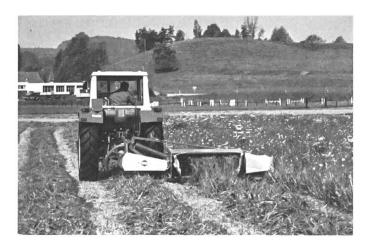
Fig. 2: Faucheuse-conditionneuse en action. Une mise en andains lâches permet souvent d'économiser une opération de fanage, car le fourrage sèche déjà suffisamment sur l'andain. Malgré cela, on tiendra compte de la règle selon laquelle deux ou trois éparpillements successifs de fourrage encore humide causent la dessication la plus rapide et un minimum de pertes d'effritement.
