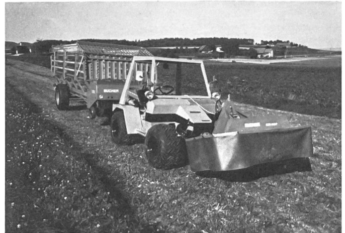
Fig. 1: Puissante faucheuse automotrice à deux essieux et dispositif de coupe à tambours frontal remorquant une autochargeuse légère.
