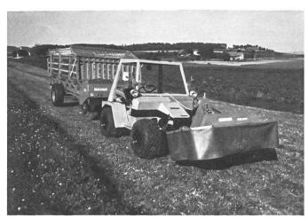
Fig. 1: Puissante faucheuse automotrice à deux essieux et dispositif de coupe à tambours frontal remorquant une autochargeuse légère.
