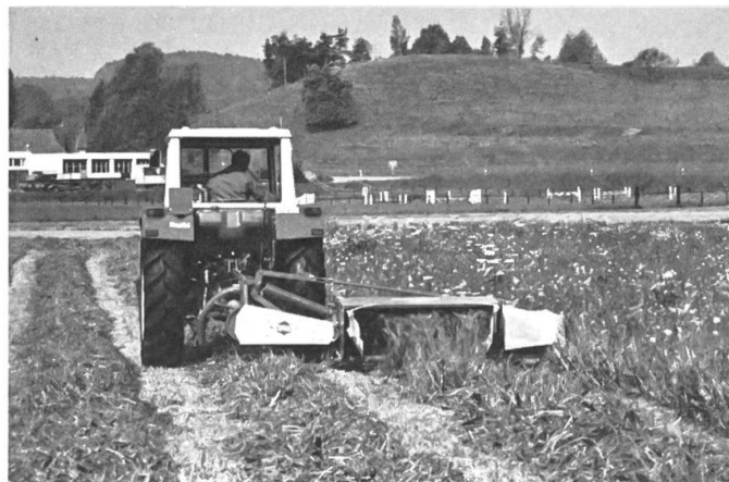
Fig. 2: Faucheuse-conditionneuse en action. Une mise en andains lâches permet souvent d'économiser une opération de fanage, car le fourrage sèche déjà suffisamment sur l'andain. Malgré cela, on tiendra compte de la règle selon laquelle deux ou trois éparpillements successifs de fourrage encore humide causent la dessiccation la plus rapide et un minimum de pertes d'effritement.
