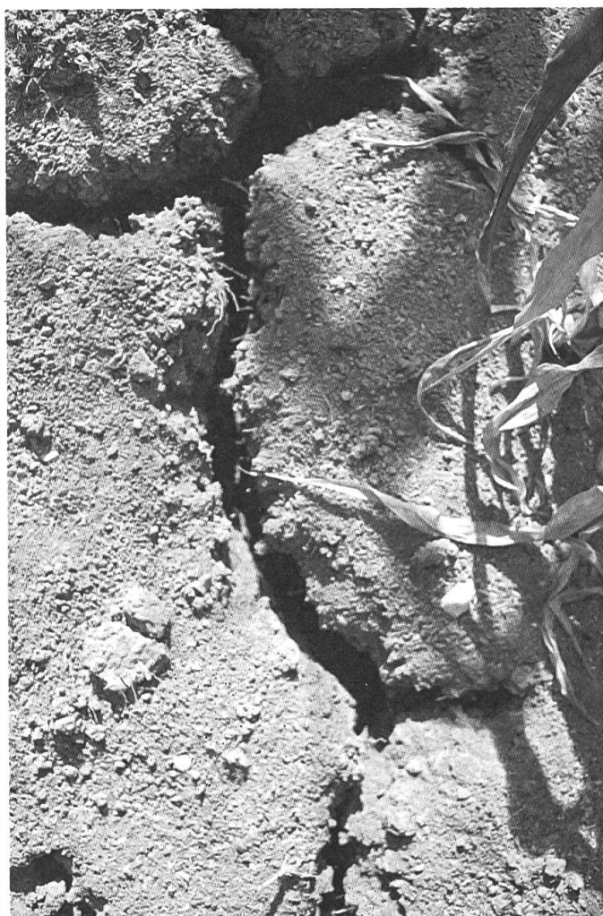
Fig. 2: Fentes sur terre argileuse provoquées par la sécheresse.
