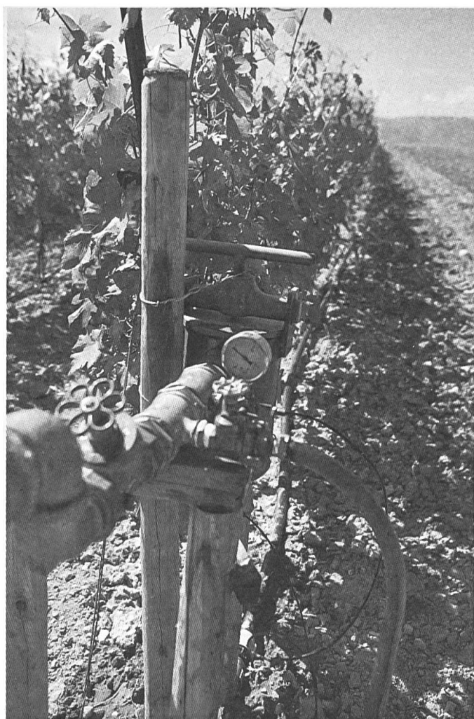
Fig. 4: Tête de filtrage pour installation d'irrigation goutte à goutte.
