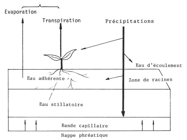
Fig. 1: Coupe transversale expliquant le bilan de l'eau du sol. (dessin: U. He.)
