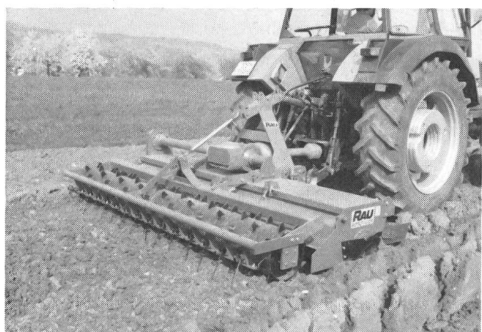
RAU-ROTOTILLER avec nouveau rouleau plombeur auto-nettoyant. Les décrotoirs sont combinés avec des dents à ressorts.
