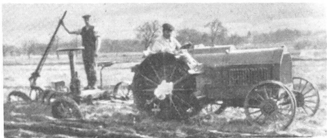
Tracteur Berna (1918), des usines Berna S.A., Olten, moteur à essence de 40 CV et 4 cyl., avec charrue Ott à 3 socs.
