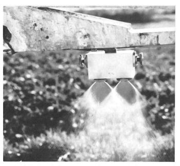
Le double-jeu de buses peut être monté dans un support spécialement conçu à cet effet. Il est équipé de filtres, de soupapes anti-gouttes et de fermeture individuelle des jets. Construction compacte, à monter sur les rampes existantes.
