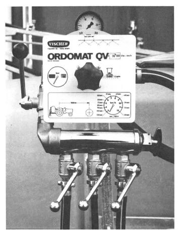
Fig. 2: Régulateur de débit ORDOMAT QV avec les indications pour 4 jeux de buses.
