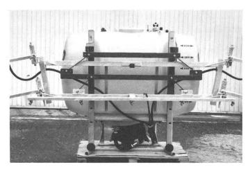
Fig. 3: Stabilisateur GRAVIMATIC pour rampe de traitement.
