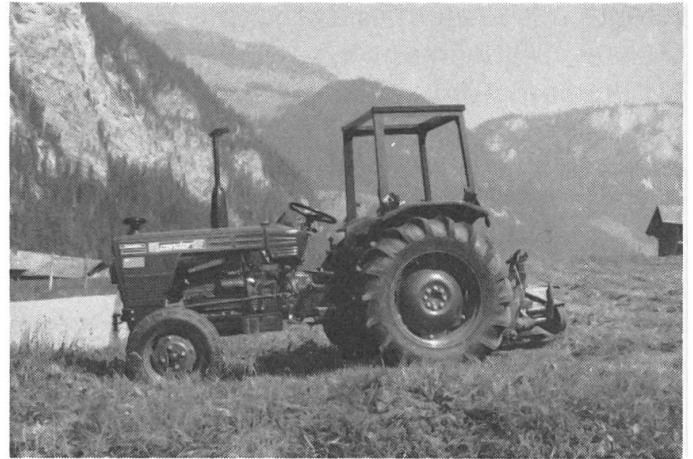
Fig. 1: Il est urgent de munir aussi les tracteurs plus anciens d'un dispositif protégeant le conducteur tel que le tracteur (plus récent) sur l'illustration. C'est la seule possibilité d'éviter les retournements à issue mortelle.
