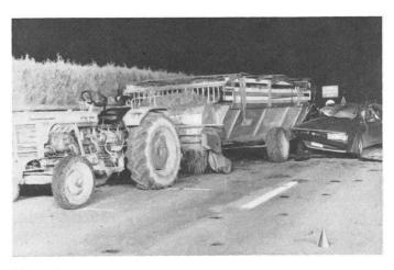
Fig. 4: Les tracteurs devraient aujourd'hui tous être munis d'installations de clignoteurs. Tamponnage de voitures dans une colonne à cause de l'éclairage faisant défaut sur la remorque.
