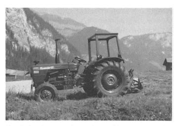
Fig. 1: Il est urgent de munir aussi les tracteurs plus anciens d'un dfispositif protégeant le conducteur tel que le tracteur (plus récent) sur l'illustration. C'est la seule possibilité d'éviter les retournements à issue mortelle.
