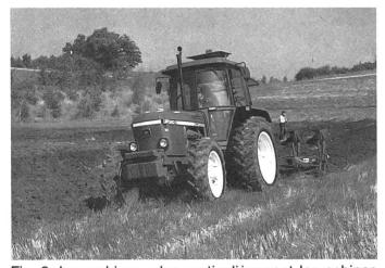
Fig. 2: Les cabines, plus particulièrement les cabines tout-confort, ne garantissent pas nécessairement plus de sécurité lors de chutes.
