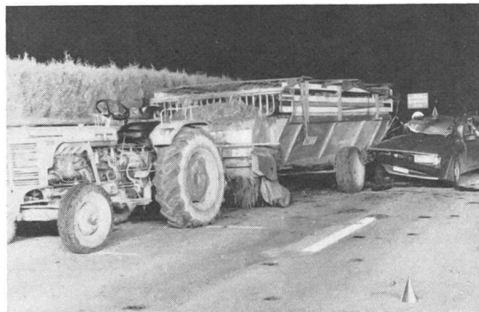
Fig. 4: Les tracteurs devraient aujourd'hui tous être munis d'installations de clignoteurs. Tamponnage de voitures dans une colonne à cause de l'éclairage faisant défaut sur la remorque.
