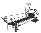
Convoyeur pour soufflerie à ruban de caoutchouc
