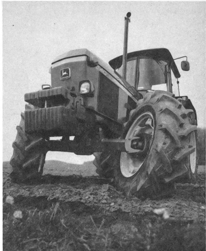
térieure de l'essieu avant permettent une conduite très précise du tracteur; il n'existe point de barres de direction avant.
