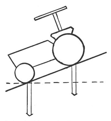
En descente: Déplacement du poids en avant, c'est-àdire en faveur des tracteurs toutes roues motricès. Cette situation peut aussi avoir de l'importance en reculant (lors d'une manœuvre) ou en freinant sur une pente.
