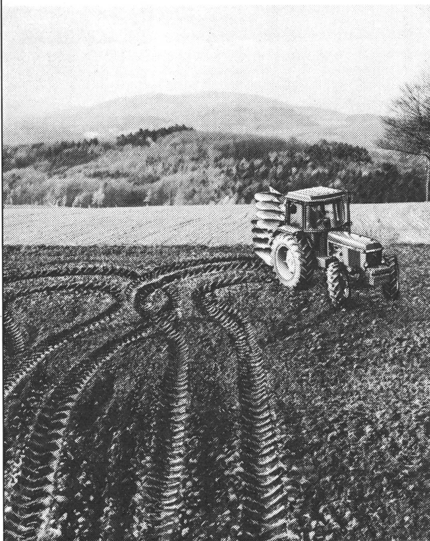
Le pont avant mécanique à roues inclinables équipe huit tracteurs John Deere de 60 à 132 ch DIN.
