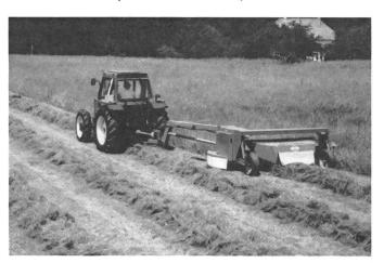
conditonneuse KUHN FC 300 peut être entraînée à volonté à raison de 540 ou 1000 tr/min. La puissance nécessaire à la prise de force est de 55 kW (75 CV). La largeur de transport mesure également 3 m.
