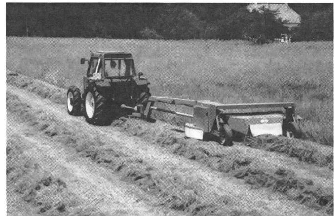
conditionneuse KUHN FC 300 peut être entraînée à volonté à raison de 540 ou 1000 tr/min. La puissance nécessaire à la prise de force est de 55 kW (75 CV). La largeur de transport mesure également 3 m.
