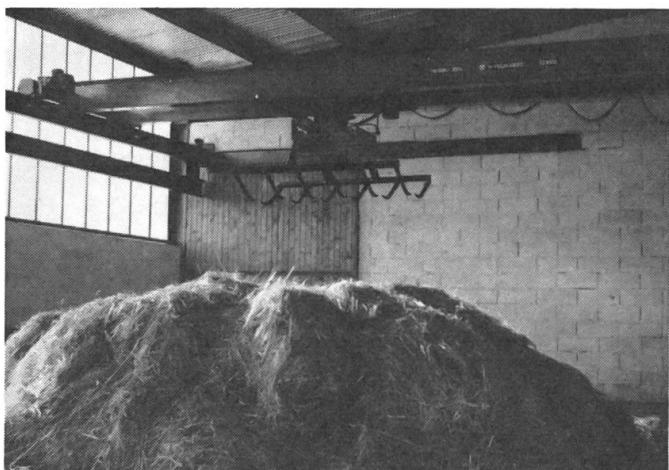
Pince à griffes hydraulique avec cadre de montagne d'une largeur de 1800 mm et dispositif d'arrêt système Krüger.
