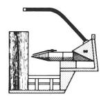
Fig. 1: Fendeuse à vis cônique horizontale.
