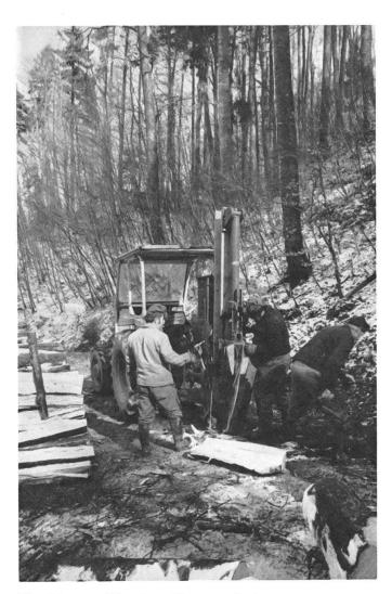
Fig. 6 La machine travaillant verticalement permet une position droite et détendue. Les efforts de transport, de mise en place et d'empilage sont réduits à un minimum. (Photo: IFRF)
