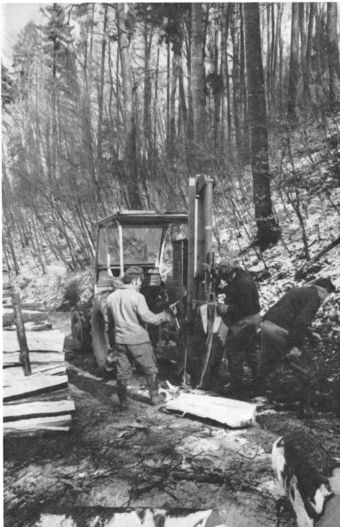
Fig. 6 La machine travaillant verticalement permet une position droite et détendue. Les efforts de transport, de mise en place et d'empilage sont réduits à un minimum.
