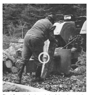
Fig. 4 Sur cette fendeuse à vis cônique, la protection empêchant la rotation du rondin est efficace pour des bois de 1 m. Le danger d'accidents élevé résultant d'un contact involontaire de la vis est manifeste.
