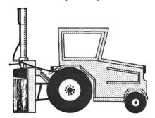
Fig. 3: Fendeuse à coin hydraulique vertical.
