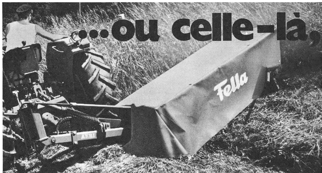
Faucheuses à disques SM 165, SM 205 et SM 240 Largeurs de travail 1,65, 2,05 et 2,40 m. 4 ou 6 disques à 2 couteaux. Commande par courroies trapézoïdales et engrenages dans bain d'huile. Dispositif de sécurité contre l'endommagement. SM 240 avec relevage hydraulique. Grande adaptation au sol et poids minime: idéal pour les exploitations de montagne et dans les terrains accidentés.
