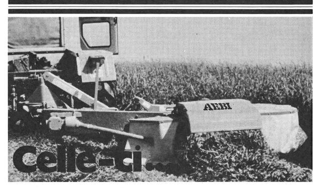
Faucheuse conditionneuse avec conditionneuse relevable et démontable. Réglage sans intervalles du degré de préparation du fourrage. Largeurs de travail 1,65, 1,90 et 2,10 m.
