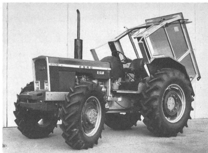
Une cabine rabattable facilite les travaux d'entretien et de réparation.
