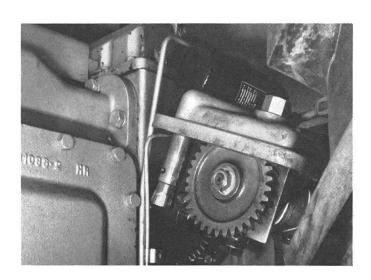
pas être démonté en cas d'avarie. Les pompes hydrauliques devraient donc être placées en dehors (par exemple à côté du moteur) ou dans un endroit facilement accessible. Voir l'illustration: couvercle amovible supportant une pompe hydraulique sur sa face intérieure et un filtre à huile sur sa face extérieure.
